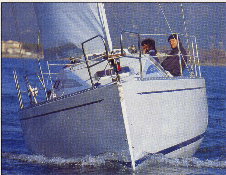
Questa immagine evidenzia le singolari linee a canoa della prua, con le fiancate che a centro barca diventano molto verticali.
