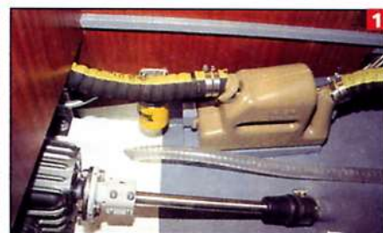
1: premistoppa del tipo senza manutenzione, waterlock Vetus, accesso facilitato.
