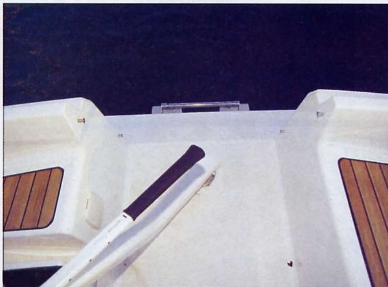
L'idea di aprire lo specchio di poppa è senz'altro pregevole, ma il sistema andrebbe rivisto, perché è scomodo e troppo macchinoso.
