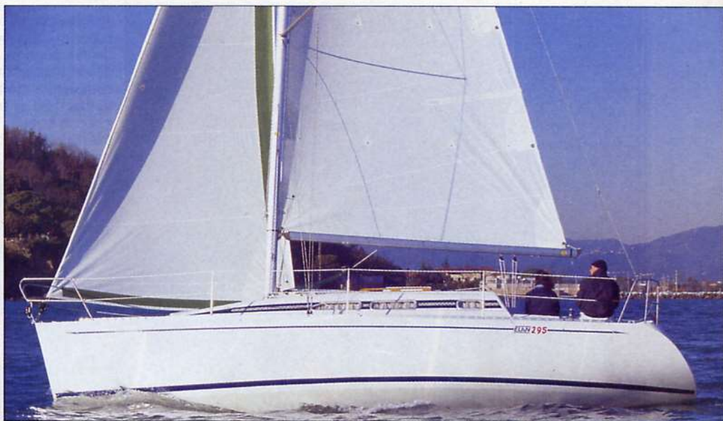
Progettato dall'inglese Robert Humphreys, l'Elan 295 appartiene all'ultima generazione degli scafi IMS, caratterizzati da pochi slanci, baglio massimo arretrato e sezioni di poppa molto pronunciate.
